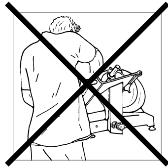
Abb. Nr.10b - verfehlte Position
