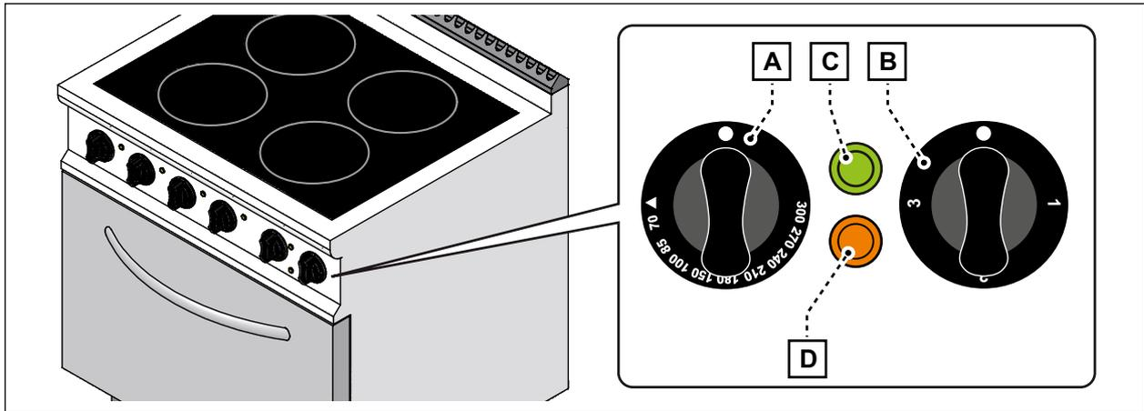
Abb. 6 Bedienblende des Elektroherdes mit Backofen
