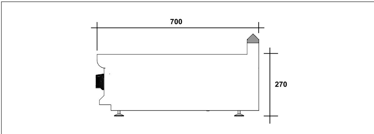
Abb. 13 Abmessungen des Glaskeramikerd-Tischgeräts
