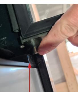
**ITA** Premere il perno inferiore per poterlo inserire nell'incavo, si deve sentire poi un "click"
