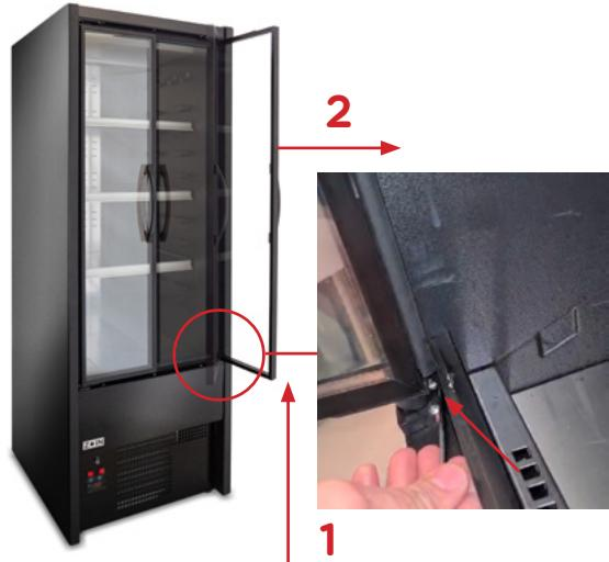
**ITA** Agire sul perno di sicurezza inferiore per sbloccarlo, alzare la porta e farla uscire dal perno inferiore
